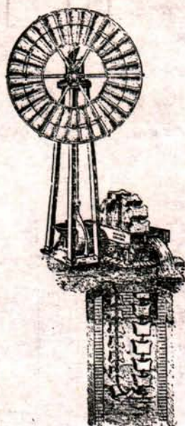
Curioso "híbrido" de molino y noria introducido en 1874 por Roldán, Lanús y Cía.
